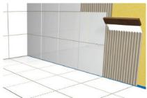
► Die Dichtbahn im Anschluss mit Fliesenkleber bestreichen und verfliesen
