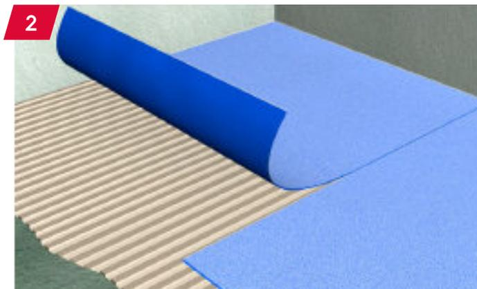
1. Tragen Sie die Entkopplungsbahn passgenau und kantengerecht auf den Boden auf und streichen diese zu den Rändern hin glatt und vermeiden Lufteinschlüsse, Klebereste und Überlappungen!
