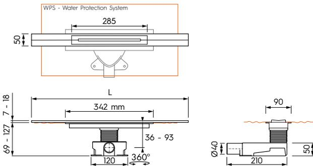
**// SPERRWASSERHÖHE 50 MM**
