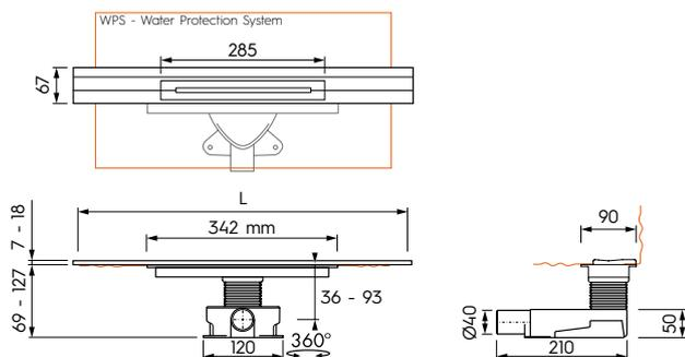
**// SPERRWASSERHÖHE 50 MM**
