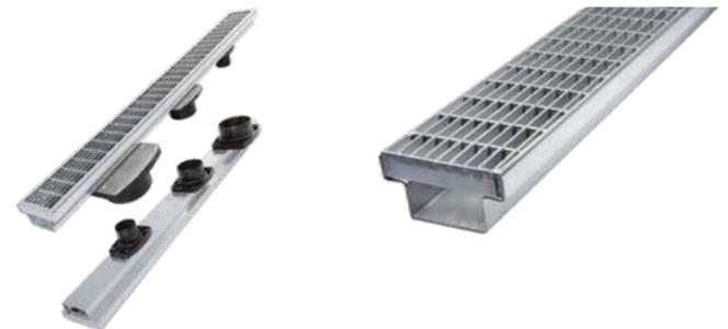
**Belastung:** begehbar, leichte rollende Lasten. Der Rinnenkörper kann als Einzelteil/Einzellänge bis 3,00 m gefertigt werden. **Standardlänge:** 1,00 m. Zwischenmaße werden auf volle Meter berechnet. Die Maschenroste werden in 1,00 m Längen geliefert.
